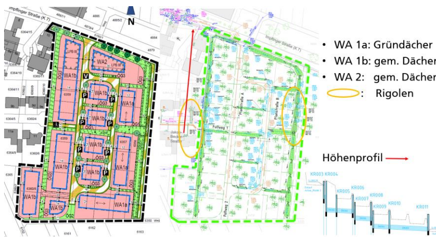
Abbildungen: Plangebiet mit Starkregengefährdungen und naturnahen Entwässerungseinrichtungen
