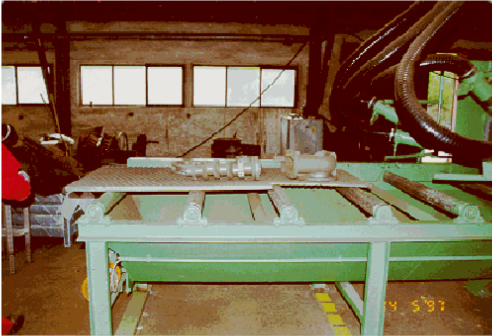
Dekontaminierte Teile auf der Bandstrahlanlage
