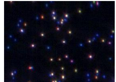
Aufnahme von Ag (50nm) / Au (80nm) NP-Mix mit Hyperspectral Imaging von Cytoviva Ltd.
