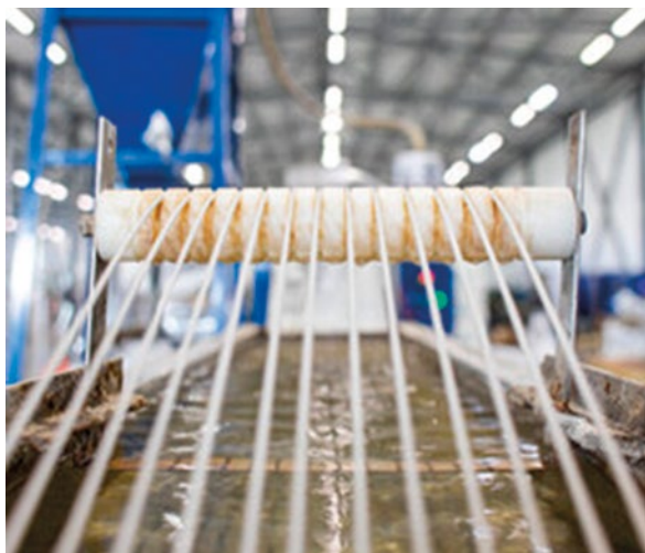
Herstellung von Polypropylengarn
