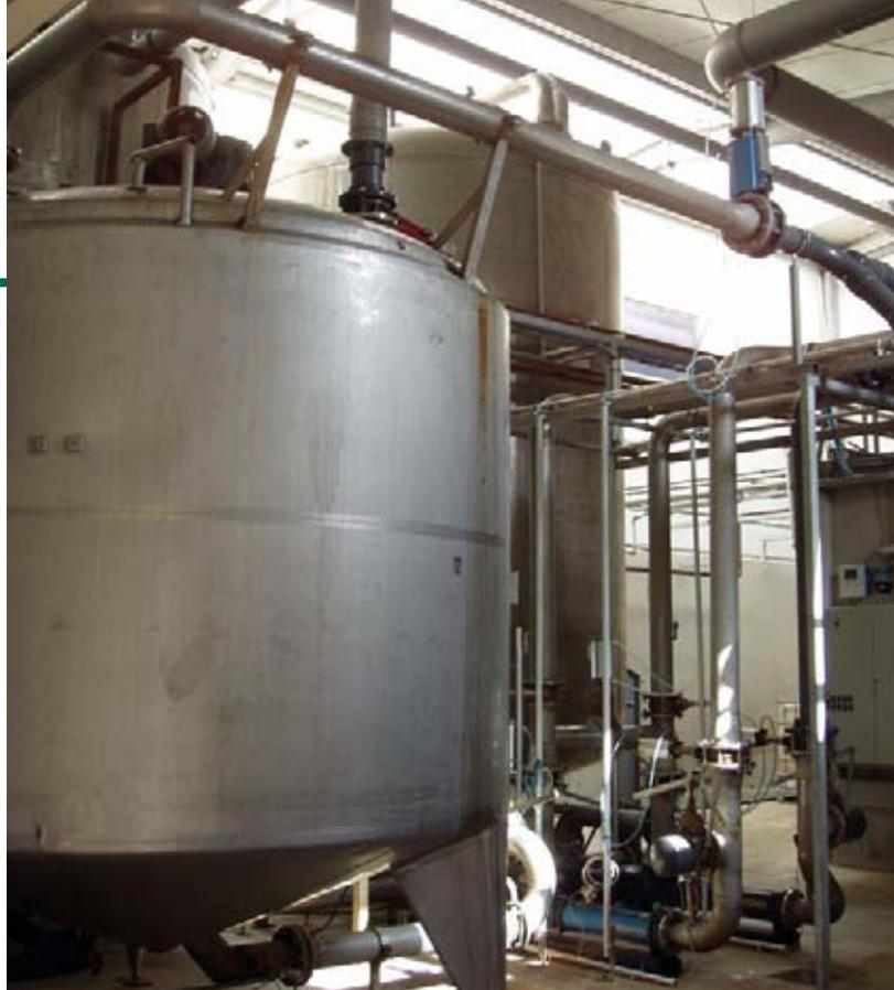
Hygienisierungsstufe der ZEUS-Biogasanlage in Reinsfeld
