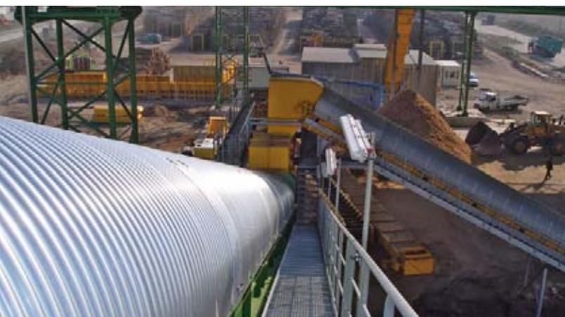
Bild oben: Brennstoffzuführung mit Überlängenabscheidung für das Biomasseheizkraftwerk Eberswald
