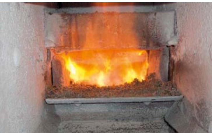
Abbrandversuch mit Tresterpellets
