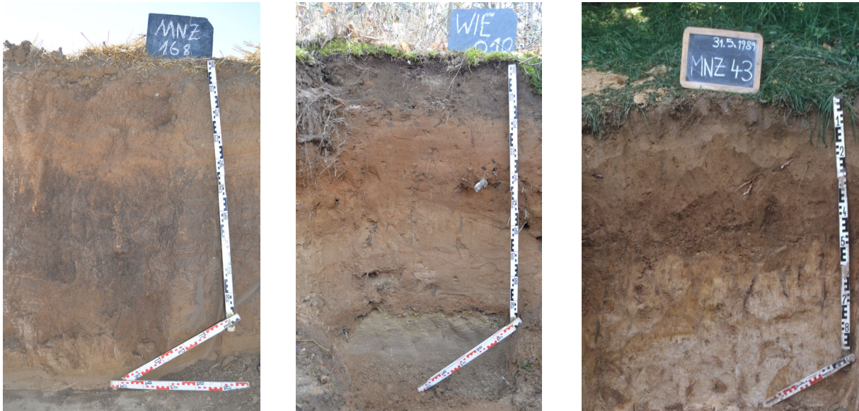
Abb. 2: Links ein Ackerboden bei Mainz (Degradierter Tschernosem aus Löss), in der Mitte ein Waldboden aus dem Lennebergwald (Braunerde aus Flugsand) und rechts ein Waldboden aus dem Ober-Olmer Wald (Pseudovergleyte Braunerde-Parabraunerde aus Arvernensis-Schottern).
