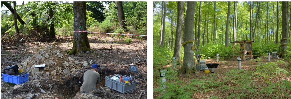
Abb. 6: Auf dem linken Foto wird ein im Zuge der Forstlichen Standortkartierung aufgegrabenes Bodenprofil bodenkundlich untersucht und beprobt. Das Foto rechts zeigt die Messeinrichtungen zur Erfassung der Stoffeinträge auf der Dauerbeobachtungsfläche „Neuhäusel“ des forstlichen Intensivmonitorings im Westerwald. Die Fläche besitzt ebenfalls eine Boden-Dauerbeobachtungsfläche und ist Teil des EU-weiten Monitoringverbunds ICP-Forests.
